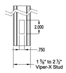
**FIGURE 3- PUNCH-OUT CONFIGURATION**
