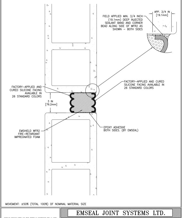
EMSEAL'S EMSHIELD WFR2 HAS BEEN TESTED IN ACCORDANCE WITH UL 2079
