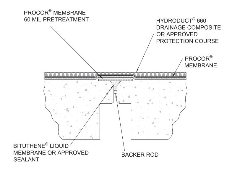
NOTE: - FOR JOINT WHERE MOVEMENT IS EXPECTED (ACTIVE JOINTS) SEE EXPANSION JOINT COVER DETAIL PRO 025.
